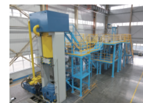
7000吨液压压力机 7000T hydraulic press
